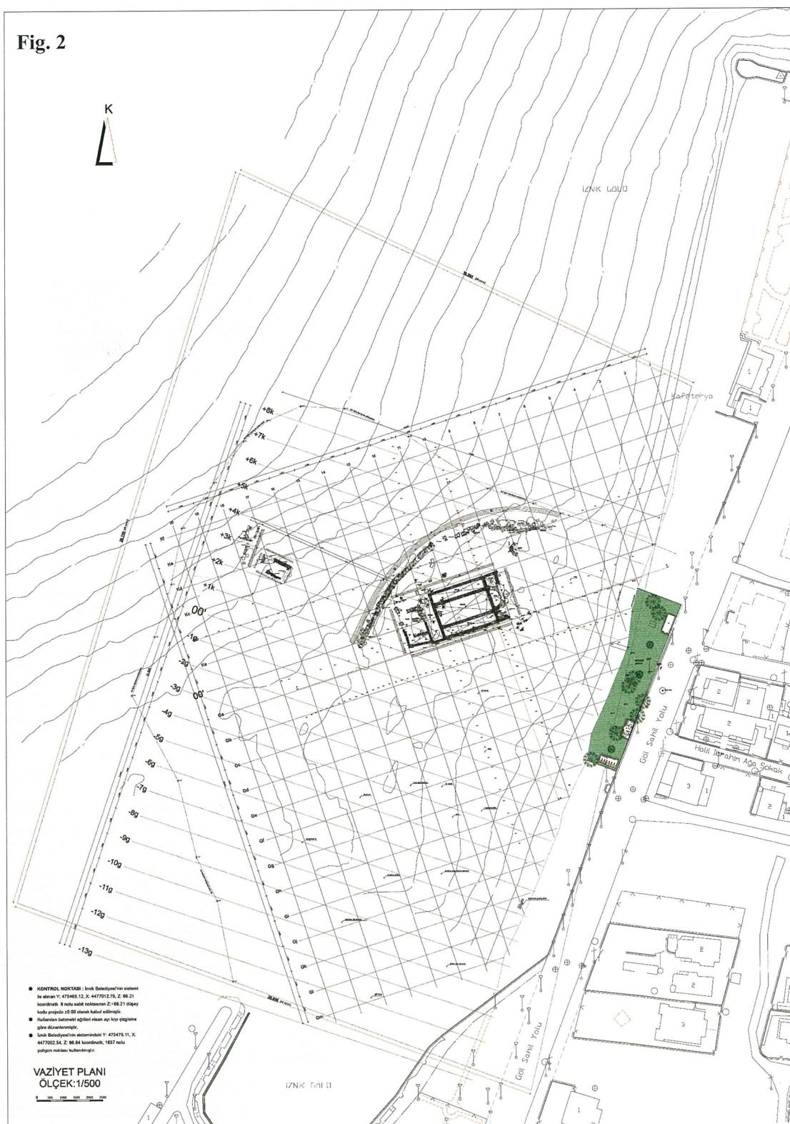
Sualtı yüzey araştırmasına ön hazırlık olmak üzere Türkiye Ulusal Koordinat Sistemi dikkate alınarak poligon atılmış, çalışma alanının tamamı 10 x 10 metre ölçülerinde karelere ayrılmış ve kareler, kuzey-güney doğrultusu harflerle, doğu-batı yönünde ise rakamlarla isimlendirilmiştir (**Fig. 2**). Böylece sualtında tespit edilecek olası kültür varlıklarının yerlerinin sağlıklı bir şekilde belgelenmesi hedeflenmiştir. Karelere numaralandırma, ön görülemeyen buluntular olması ihtimaline kar-
